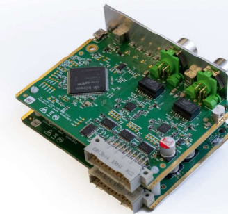
Kleinserienfertigung einer Interfaceplatine mit EtherCAT-Anschaltung
